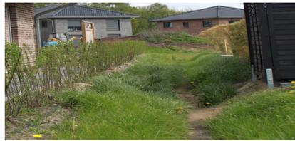
Überflutungen führen. Darüber hinaus fließt das Regenwasser in den Mulden nur langsam in die Regenrückhaltebecken, so dass auf dem Weg schon ein Teil des Wassers versickern kann.
